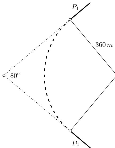
**Zadatak 4.7** Krakove  $P_1$  i  $P_2$  železničke pruge treba spojiti kružnim lukom poluprečnika 360 m. Kada bi se ova dva kraka produžila do preseka, zaklopila bi ugao od  $80^\circ$ . Izračunati dužinu kružnog luka koji će ih spojiti. Uzeti da je  $\pi \approx 3,14$ .
